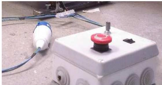
**Figura 15: Reóstato instalado en el vibrador**
