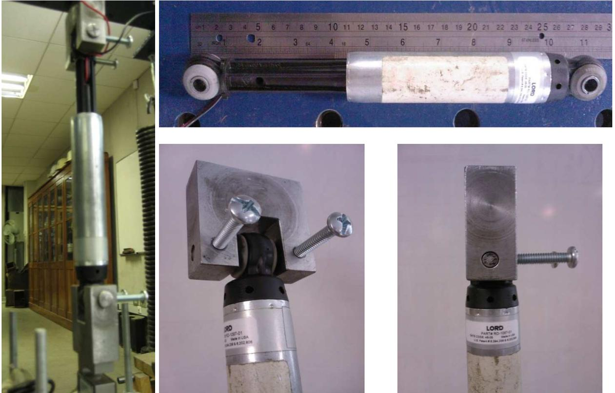
Figura 26: Fotografías del amortiguador MR modelo *RD-1097-01*, Lord Corporation y el sistema de sujeción
