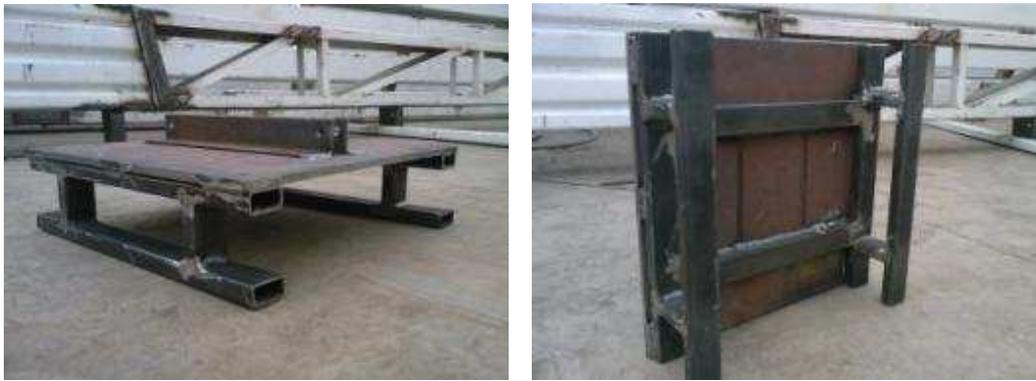
**Figura 11: Base de soporte y nivelación del excitador de vibraciones**
