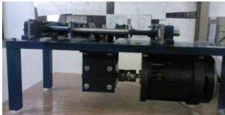
**Figura 8: Reductor de velocidad empleado en la máquina**
