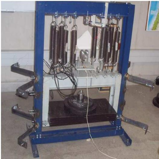
a) Configuración final del dispositivo TMD
