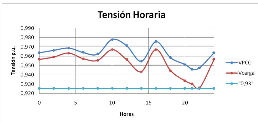
Figura 4.38: Curva de tensión diaria en las barras de carga y PCC.
