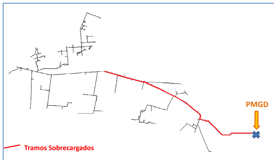
Figura 5.8: Tramos sobrecargados dentro del Alimentador para escenarios relacionados con Generación Máxima
