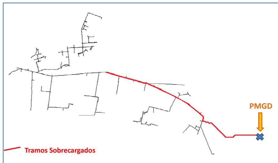
Figura 5.6: Tramos sobrecargados dentro del Alimentador para escenarios relacionados con Generación Máxima
