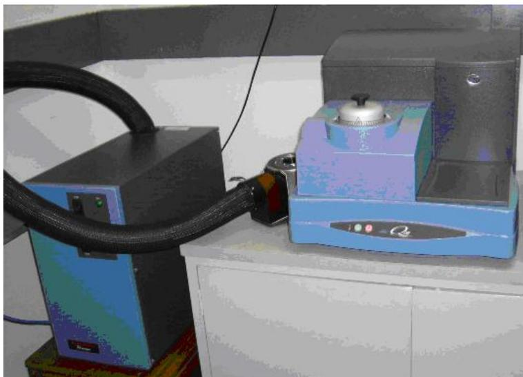
Figura 2.4: Equipo DSC Q20, TA Instruments.
