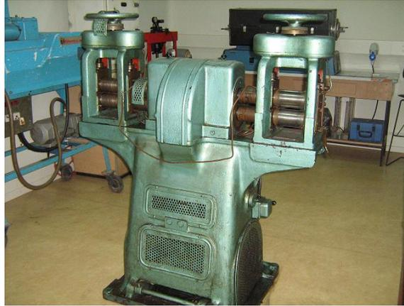
Figura 4.2: Máquina laminadora utilizada para el trabajo en frío.
