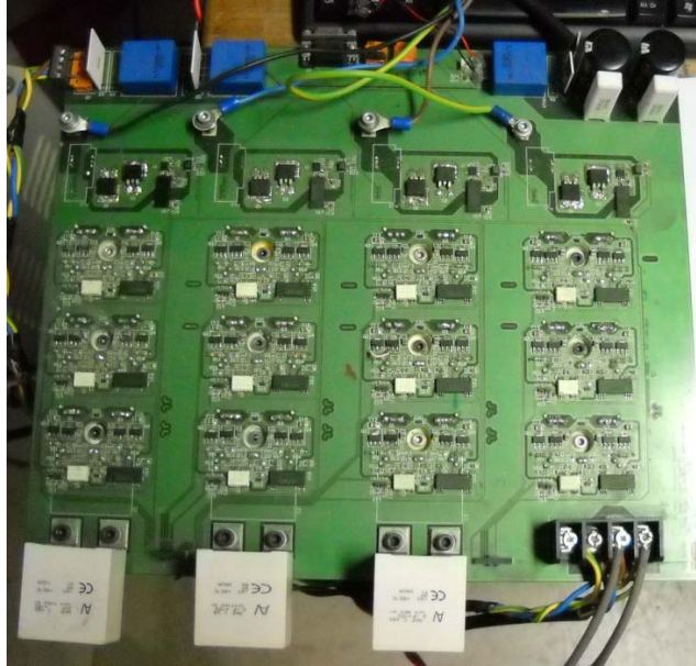
Figura 2.7: Convertor matricial 3x4 en laboratorio
