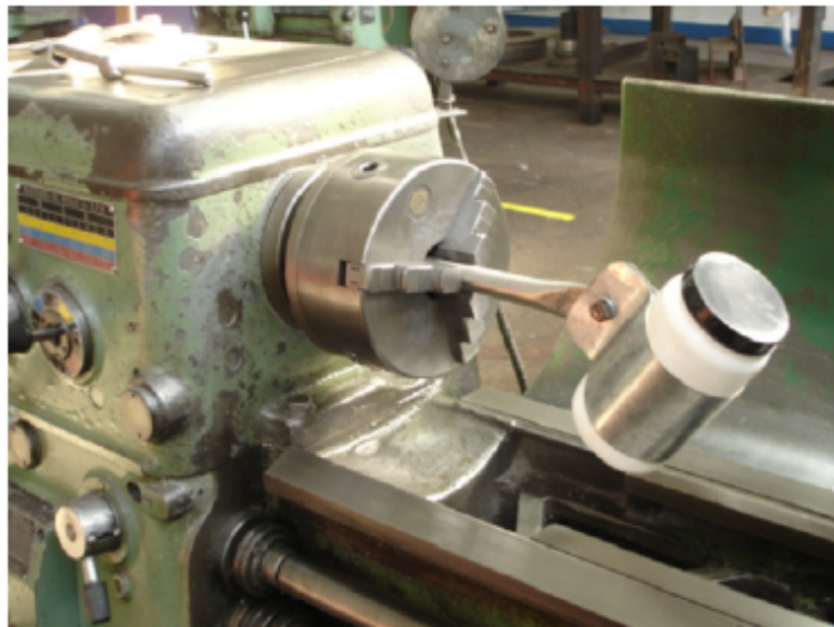
Figura 3.4: Fotografía de la disposición experimental para la mezcla de polvos.[1]
