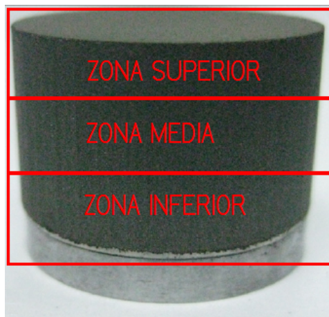
Figura 3.1: Probeta compactada en verde.
