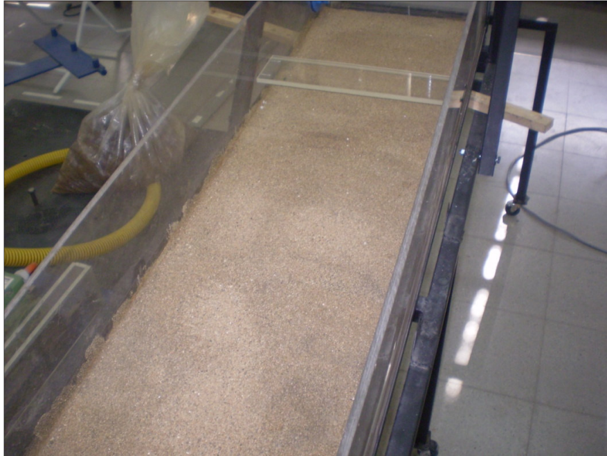
Figura 26: Capa de Arena sobre el Canal
