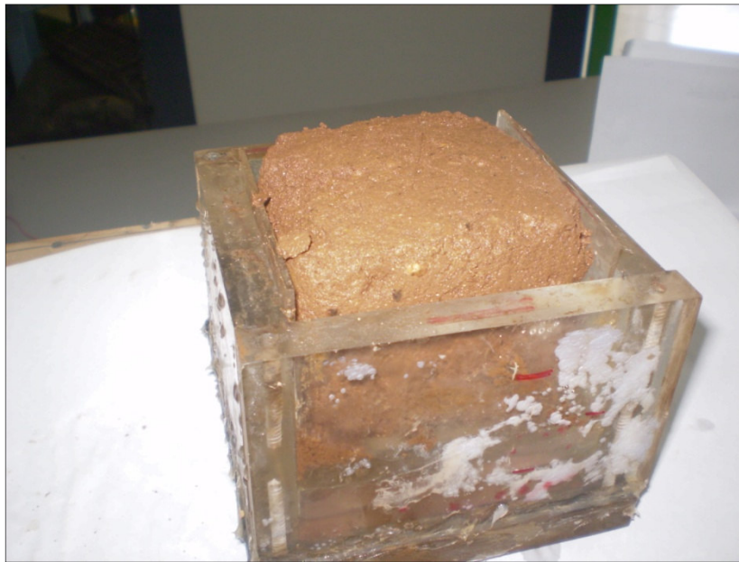
Figura 55: Erosión en Muestra Natural, Sector 4, 1er Caudal
