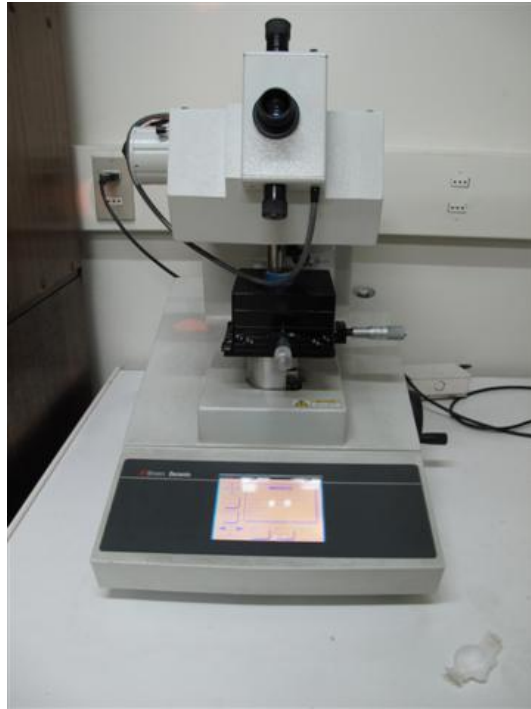
Figura 3.2. Durometro Strues Dinamin, identador Vickers.
