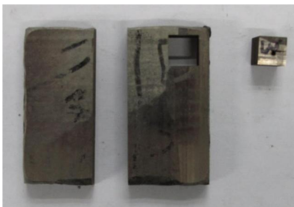
Figura 4.2. Probeta Durmat 59 PTA cortada por electroerosión.
