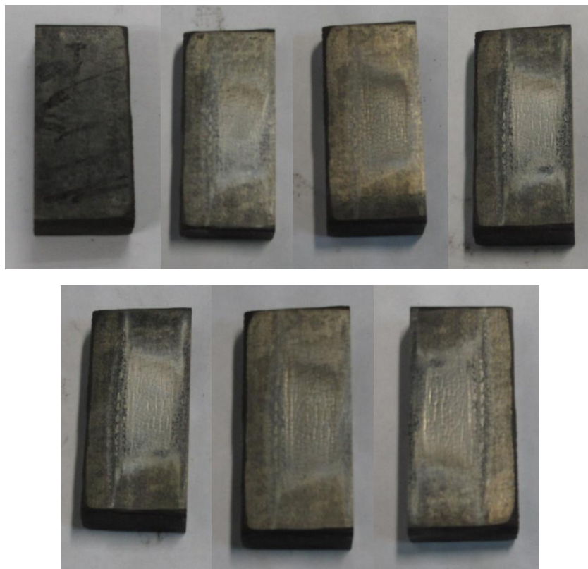
Figura 5.37. Secuencia de desgaste de probeta con recubrimiento Durmat 101 HVOF.
