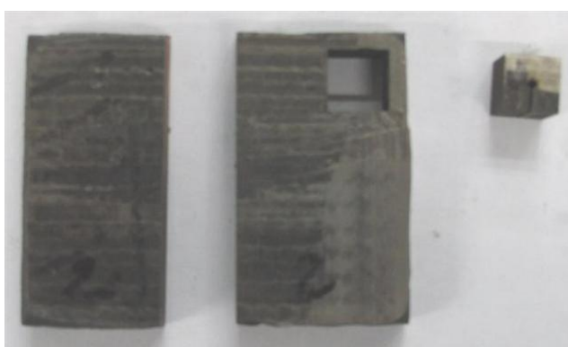
Figura 4.4. Probeta Durmat 62 PTA cortada por electroerosión
