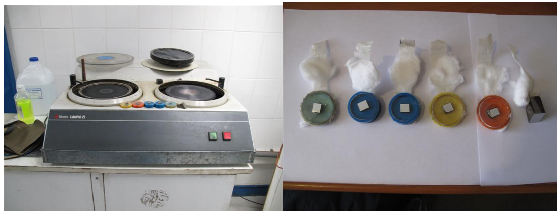
Figura 4.6. Izquierda, máquina de pulido. Derecha, muestras pulidas para microscopía y micro-dureza.
