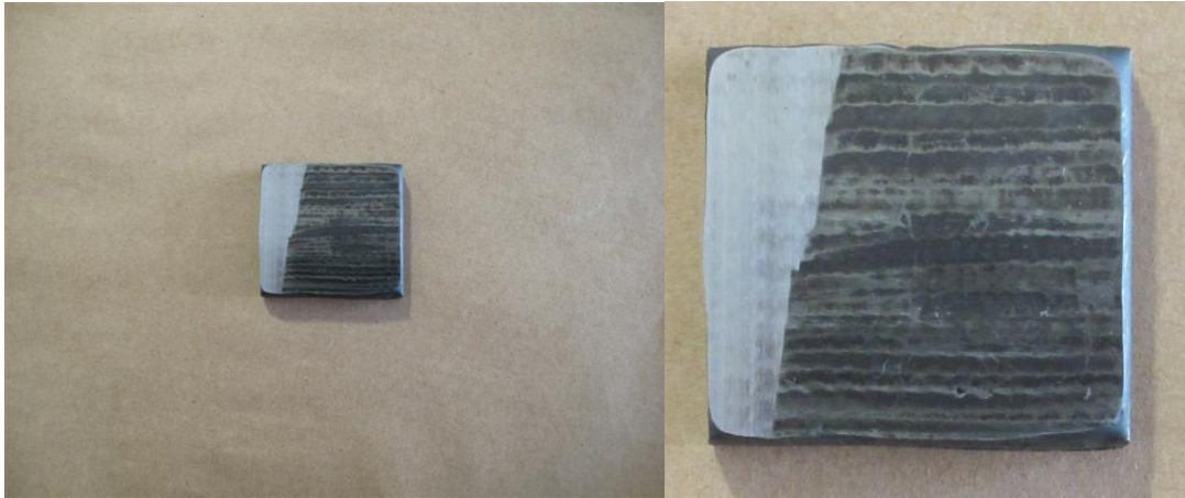
Figura 5.3. Probeta recubierta con Durmat 505 PTA
