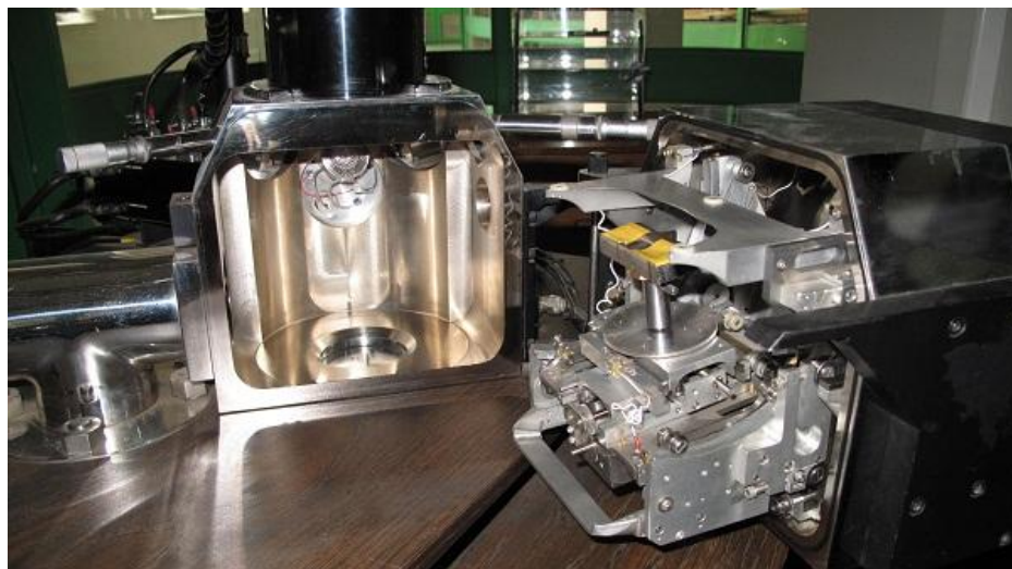
Figura 4.8. Montaje de probeta en la cámara del SEM
