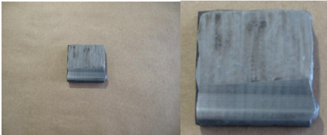
Figura 5.2. Probeta recubierta con Durmat 62 PTA
