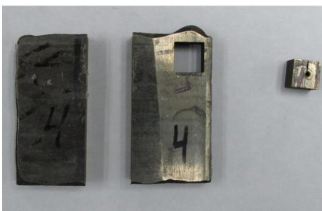
Figura 4.3. Probeta Durmat 62 PTA cortada por electroerosión
