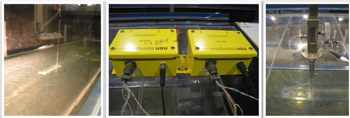
**Figura 2.7:** (izq) Probeta empleada para la fijación de los cables capacitores en su posición de medición en el eje central del túnel semi-sumergida en el volumen de agua (centro) Par de sensores de capacitancia en operación master-slave, envían a la tarjeta de adquisición una señal analógica de voltaje que es lineal a la sumergencia de cada uno de los cables delgados (der) Regleta de precisión para el desplazamiento vertical de la probeta, permite la calibración del instrumento.
