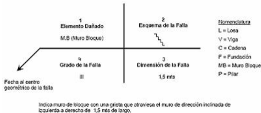
Figura 3. 1. Individualización del daño
