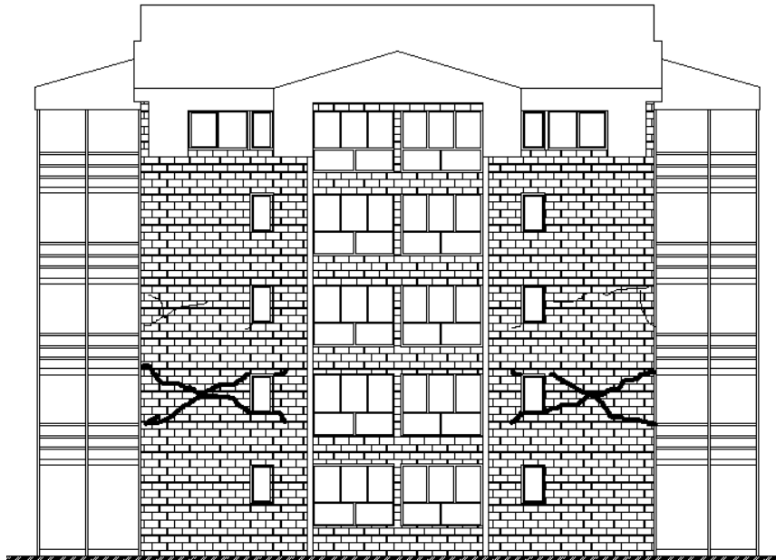
Figura 3. 17. Formas de Falla observadas en fachada eje Y, edificio 5 pisos
