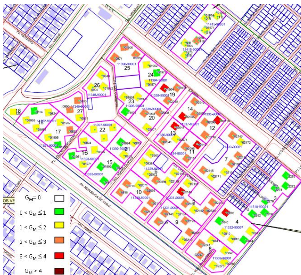
Figura 3. 9. Distribución Grado Medio de Daño en el piso con mayor daño de la Villa Cordillera
