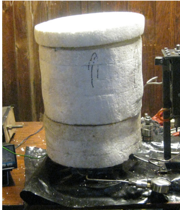
Gráfico 4.9: Cámara de alta presión con camisa aislante instalada.
