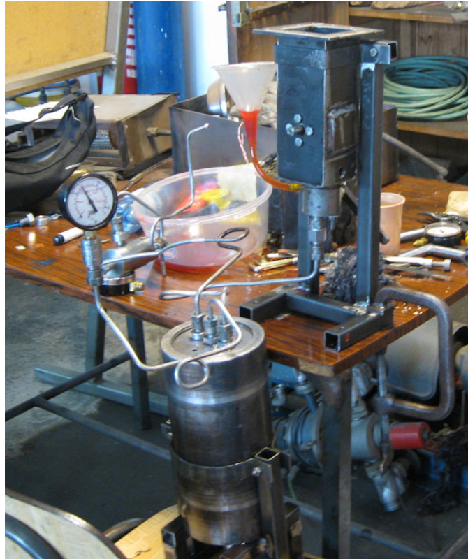
Imagen 4.10: Montaje usado en las pruebas de presión.
