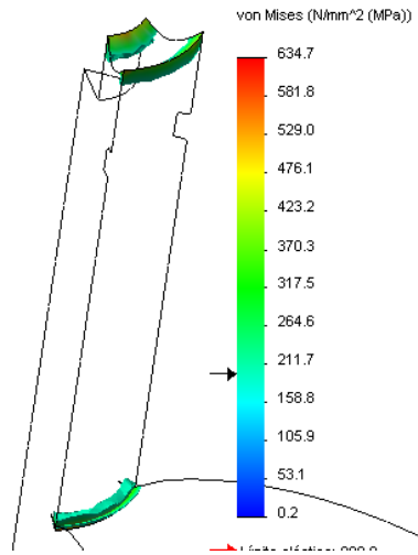
Figura A.18: Detalle concentración de esfuerzos máxima.
