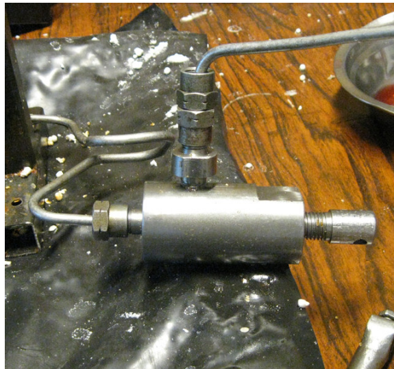
Imagen 4.6: Válvula del sistema de presión.
