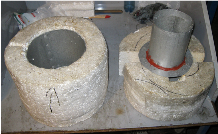
Imagen 4.7: Camisa aislante térmica desarmada.
