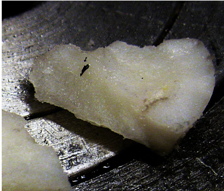
Imagen 4.11: Hielo obtenido en proceso HPSF.
