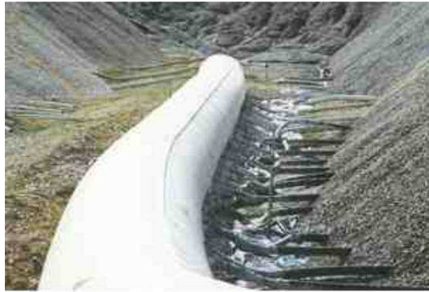
Imagen 1.3: Línea de aireación en una pila de biolixiviación [6].
