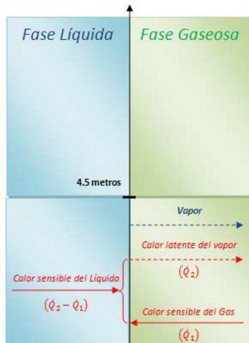
Figura A3.1: Ilustración de la transferencia de calor y masa a lo largo del lecho mineral; Caso 1 y 2.
