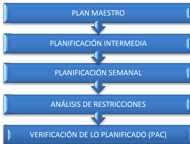
Figura 5. Proceso de Planificación Last Planner
