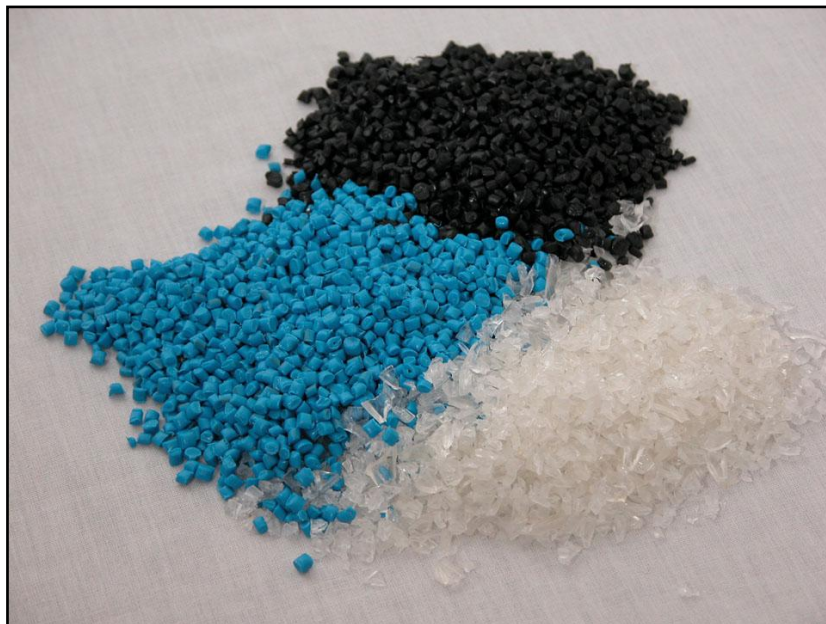
Figura 4: Pellets de polietileno Fuente: Plásticos Rivadil S.L. ( http://www.rivadil.es )
