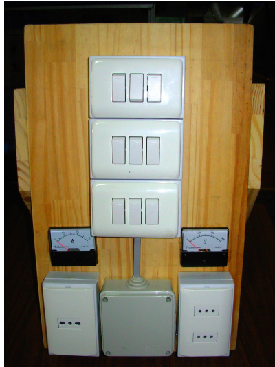
Figura 3.9: Una de las 3 cargas eléctricas (iguales) fabricadas para representar el consumo eléctrico de la turbina. [Elaboración propia]
