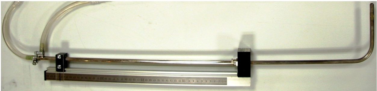
Figura 3.11: Tubo de pitot utilizado para la medición de altura neta equivalente. [Elaboración propia]
