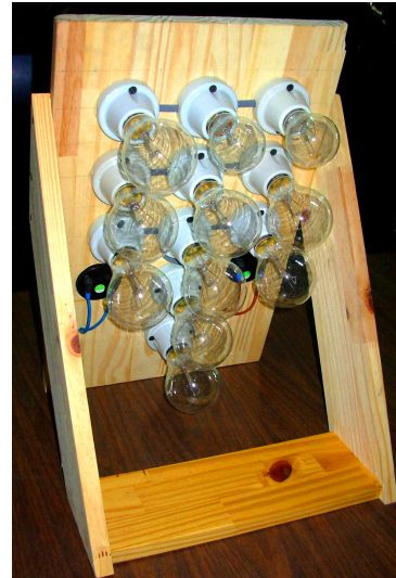
Figura 3.9: Una de las 3 cargas eléctricas (iguales) fabricadas para representar el consumo eléctrico de la turbina. [Elaboración propia]
