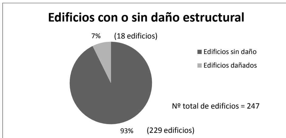
Figura 4. 6: Gráfico que indica los edificios con o sin daño estructural
