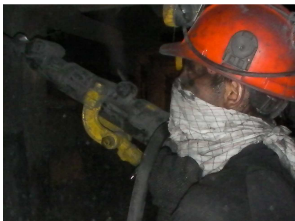
Figura 12: avance con martillo en la frente.
