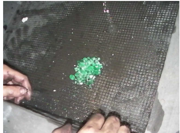
Figura 58: Lavado manual de mineral
