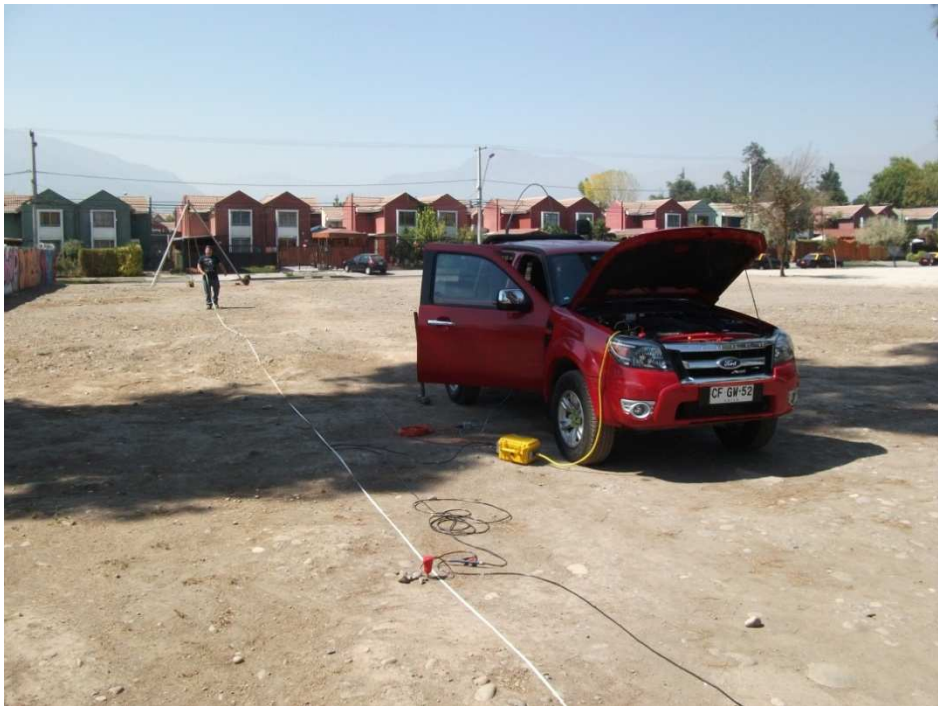
Fotografía 3: Instalación de los equipos en la medición del subsuelo de la Estación de Puente Alto
