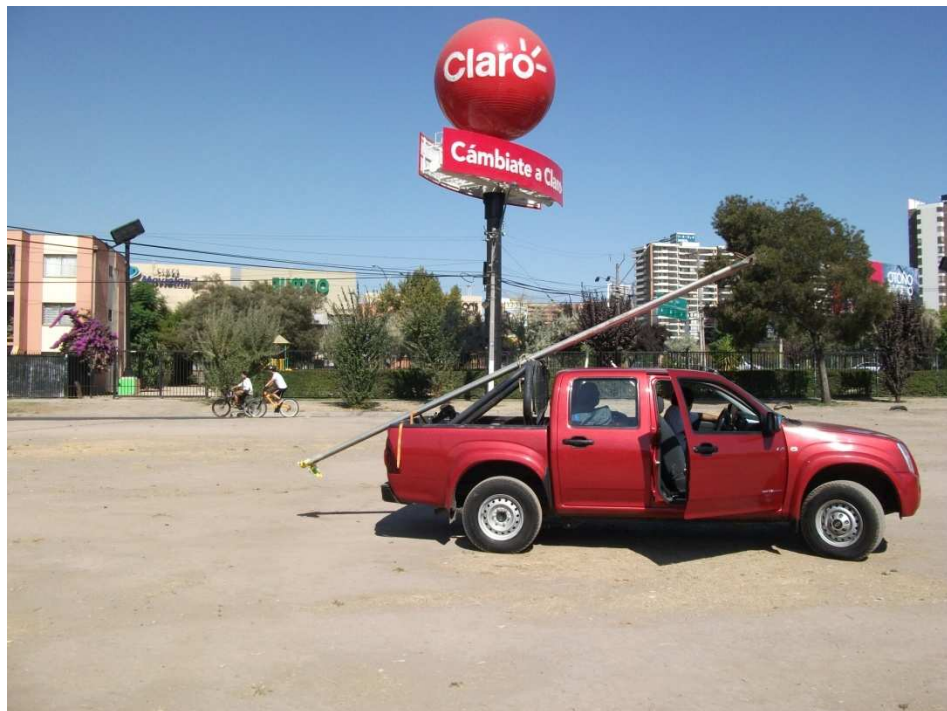
Fotografía 5: Montaje del trípode en la camioneta para su transporte. Medición del subsuelo de la Estación de Mirador
