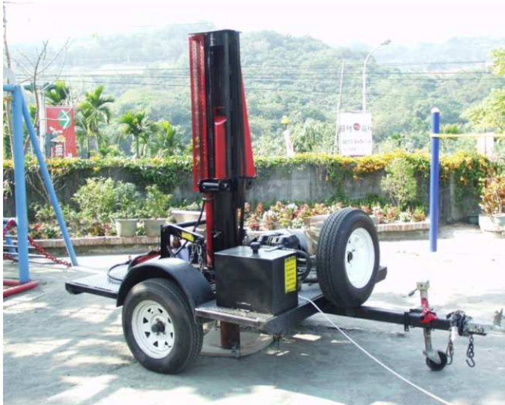
Figura 4.1: Martillo hidráulico empleado para ensayos de SASW. (K. Stokoe, 2005)
