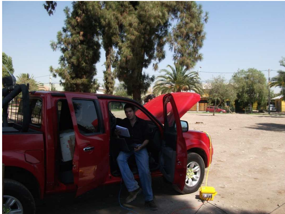
Fotografía 4: Geode y laptop usado en las mediciones. Estación de Puente Alto
