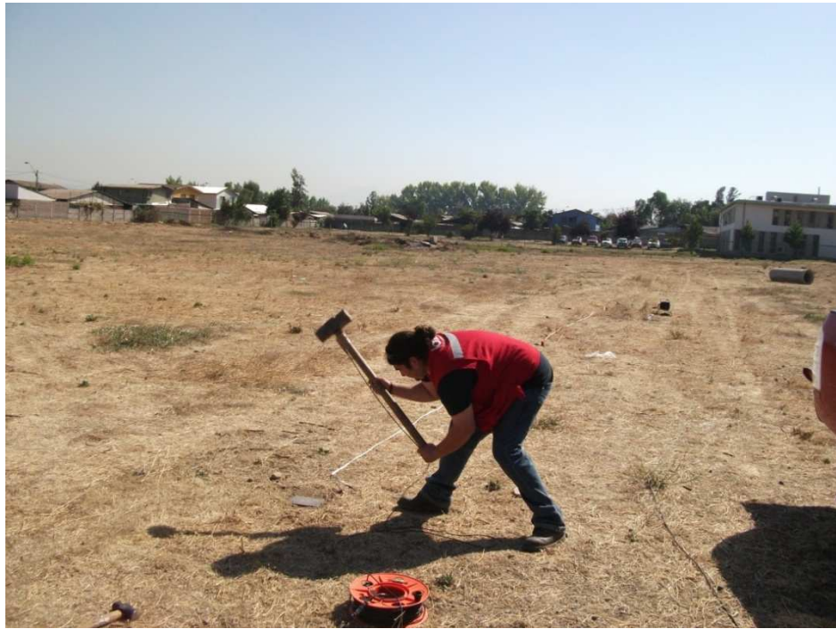
Fotografía 2: Ejecución de los golpes con el combo de 12.5 kg. Estación de Peñalolén
