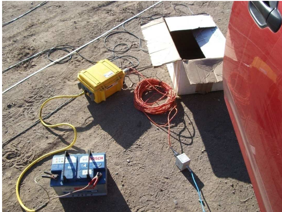
Fotografía 14: Equipos electrónicos utilizados en las mediciones. Se puede ver en esta fotografía la textura fina del suelo de la Estación de Constitución
