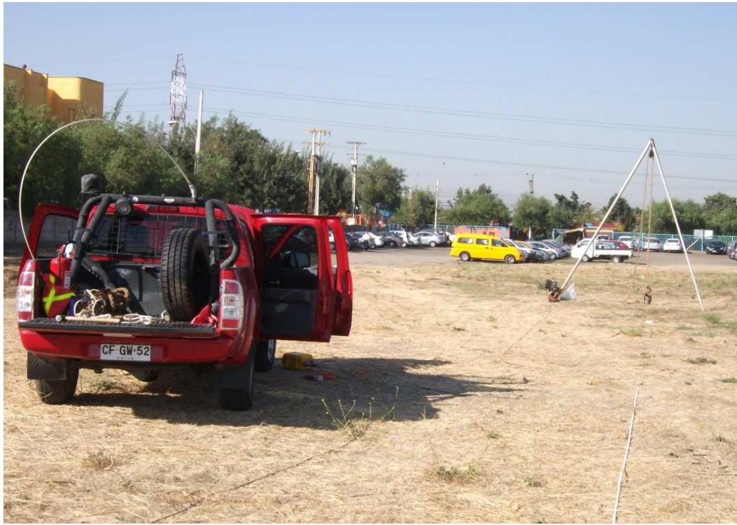
Figura 4.2: Sistema del trípode con la masa de 63.5 kg ejecutando golpes en la Estación de Peñalolén.
