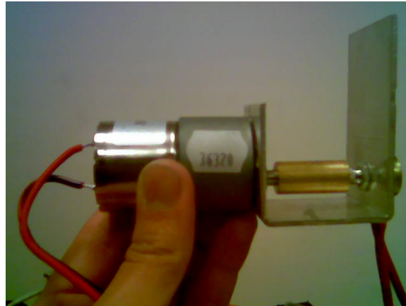
Figura 7.17: Aspecto físico del servomotor para el control del motor de CC
