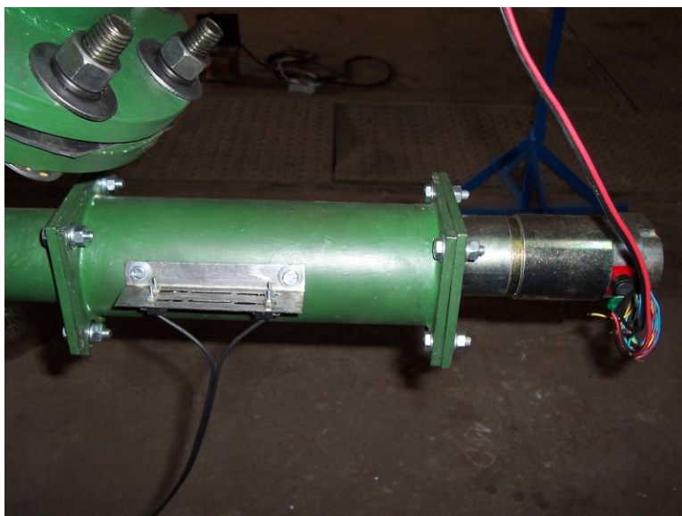
Figura 7.27: Montaje del servomotor en conjunto con el vástago de la válvula de aguja
