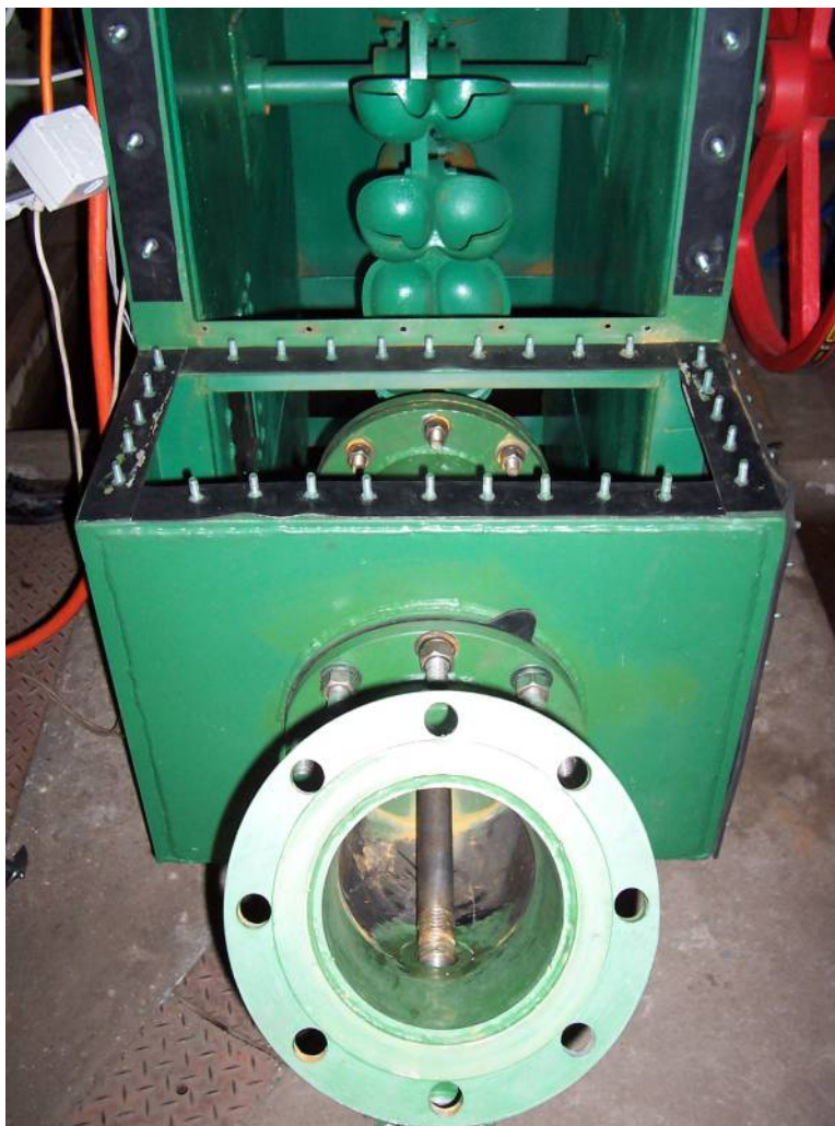
Figura 7.29: Vista frontal de la turbina destapada. Se observan las cazoletas, rodete e inyector en el interior.
