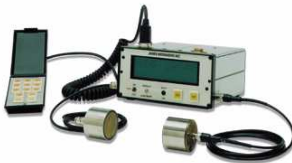
Imagen 7.1: Equipo de impulso ultrasónico.
