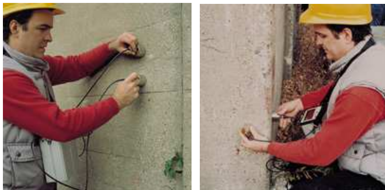
Imagen 7.2- 7.3: Equipo de impulso ultrasónico usado en terreno.
