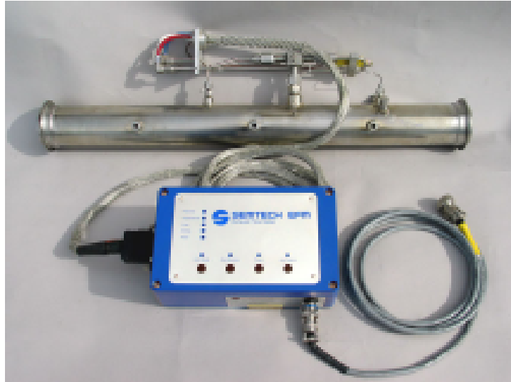
Figura 3.5: Medidor de Flujo de escape y tomador de muestra.
