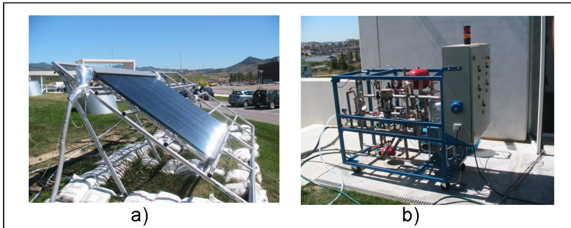
Figura 2.6: Banco de pruebas en laboratorio CENER, Pamplona, España. a) Módulo estructura soporte. b) Módulo componentes.
