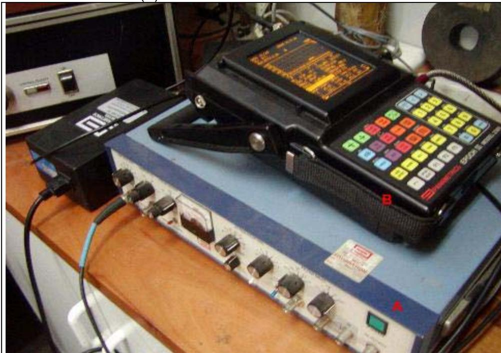
Figura 9. Generador Ultrasónico de Potencia 500 W. Modelo LC. – 9601.
