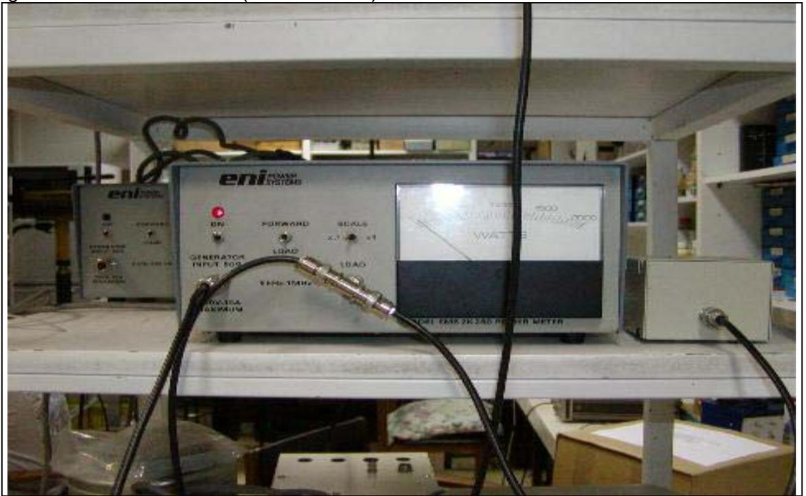
Figura 11. Generador Ultrasónico de Potencia 500 W. Unidad de adaptación. Modelo LC-9301.
