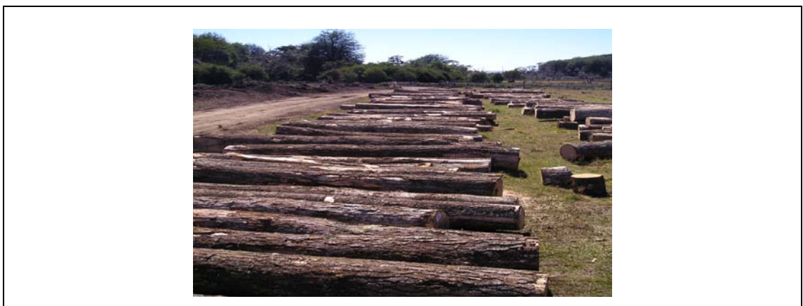
Figura 3: Trozas de los árboles seleccionadas para la obtención de probetas.
