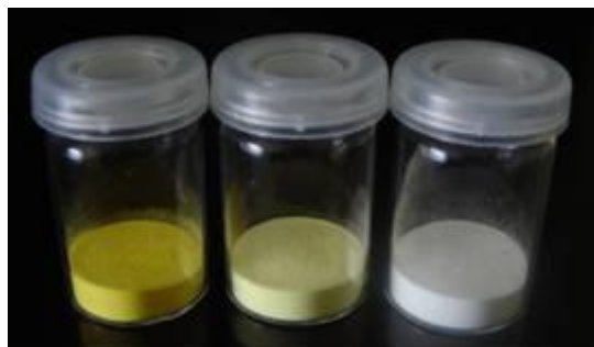
Figura 15. Nanocompositos resultantes de la mezcla de sulfuro de cadmio y sulfuro de zinc en diferentes proporciones, con surfactante.
