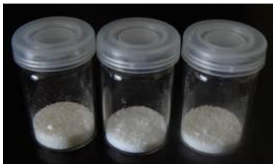
Figura 16. Nanocompositos de óxido de zinc con octadecilamina, dodecilamina y decilamina (de izquierda a derecha).
