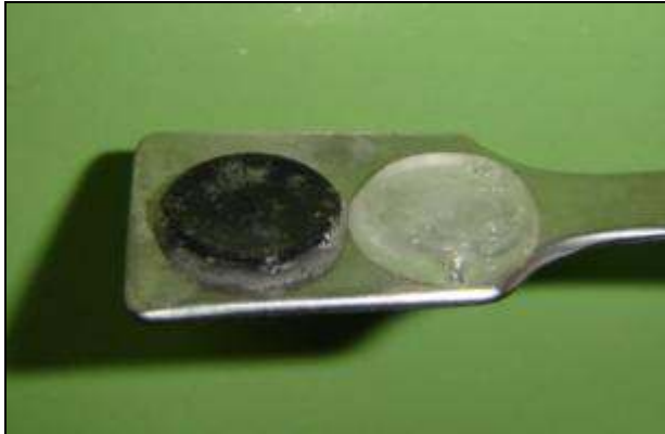
Figura 8 Fase Mixta y fase PDMS sol-gel
