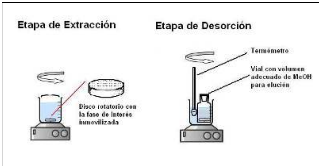
Figura 9 Esquema extracción- desorción
