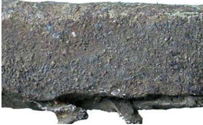
B: Porción central del fragmento de barra de Aldea el Peral. La imagen 1 presenta el lado liso y la imagen 2 el lado martillado, notar los rebordes en la superficie..
