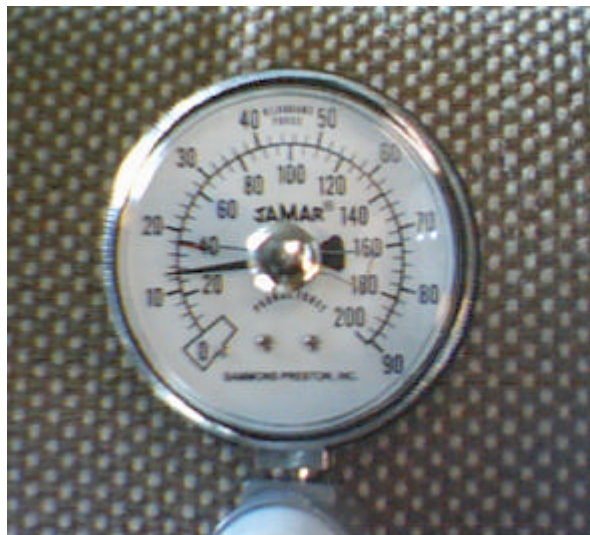
Figura 2. Dinamómetro Jamar. Para este estudio se tabularon los datos en kg. En este caso el visor marca 18 kg.
