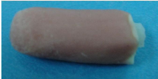
Foto N° 2: cuerpo de prueba con mango de acrílico.
