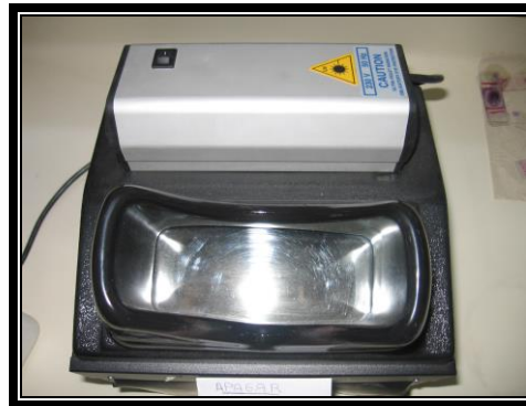
Figura 9: Visor de luz UV con lámpara UV de 360nm y cámara oscura, el cual permite observar e identificar las colonias que son capaces de emitir fluorescencia bajo luz UV
