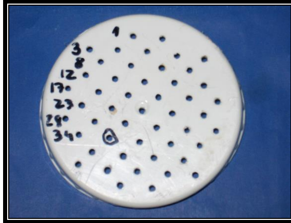
Figura 2: Replicador manual utilizado en el estudio de CIM para el depósito de alícuotas de la suspensión de Porphyromonas gingivalis
