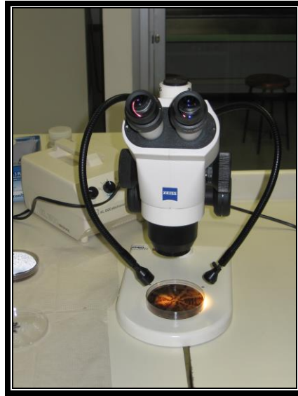
Figura 6: Lupa estereoscópica (Stemi 2000C, Zeiss) para el análisis colonial de los aislados bacterianos, y placa de agar Columbia con desarrollo bacteriano
