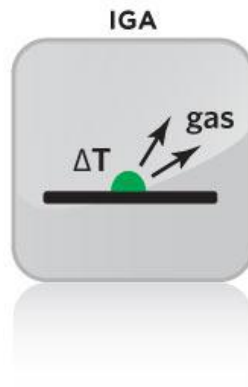
Figura 8: Esquema IGA. La muestra es vaporizada en un horno, y los gases resultantes son medidos mediante sensores de conductividad térmica o infrarrojos.
