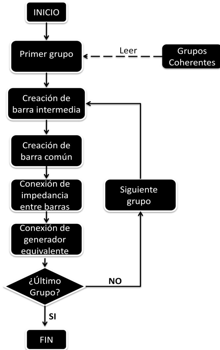
Figura 3.13 Diagrama de agregación dinámica
