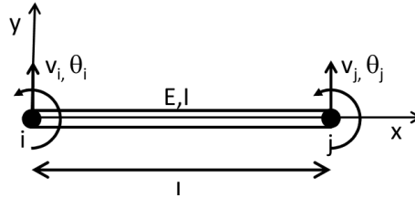
Figura 6: Elemento tipo viga (en flexión).
