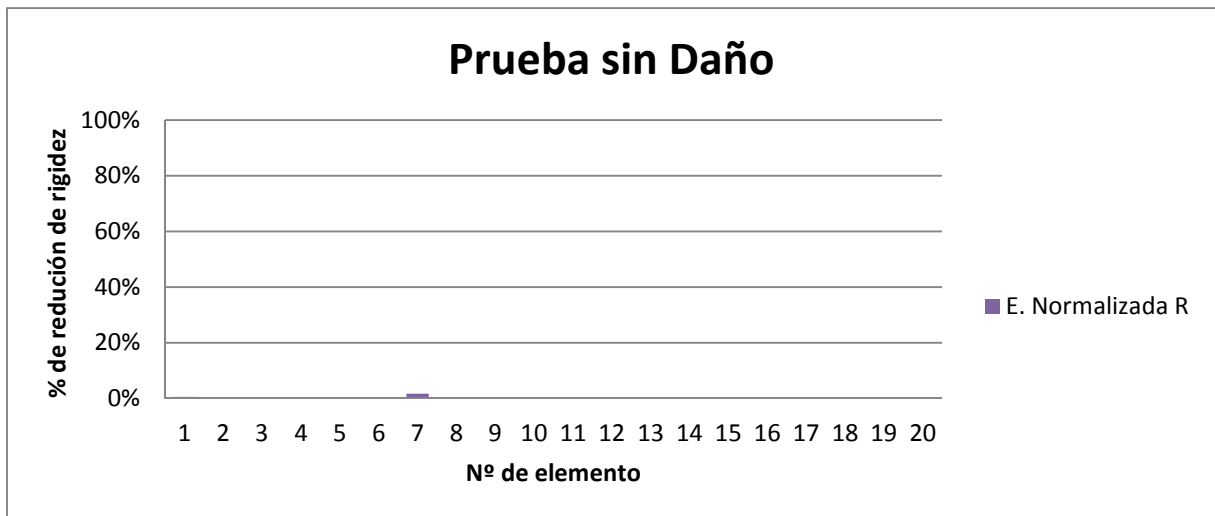
Figura 62: Resultados detección caso experimental 0 (Sin daños).
