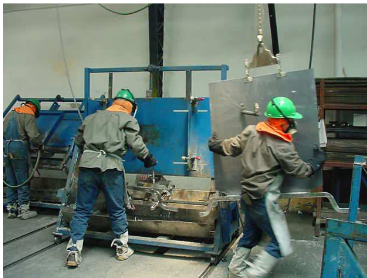
Figura 5.6: Mesas de armado de ánodos.
