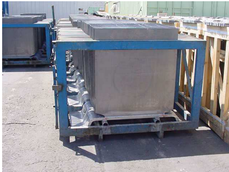
Figura 4.26: Ánodos a la espera del control de calidad final.
