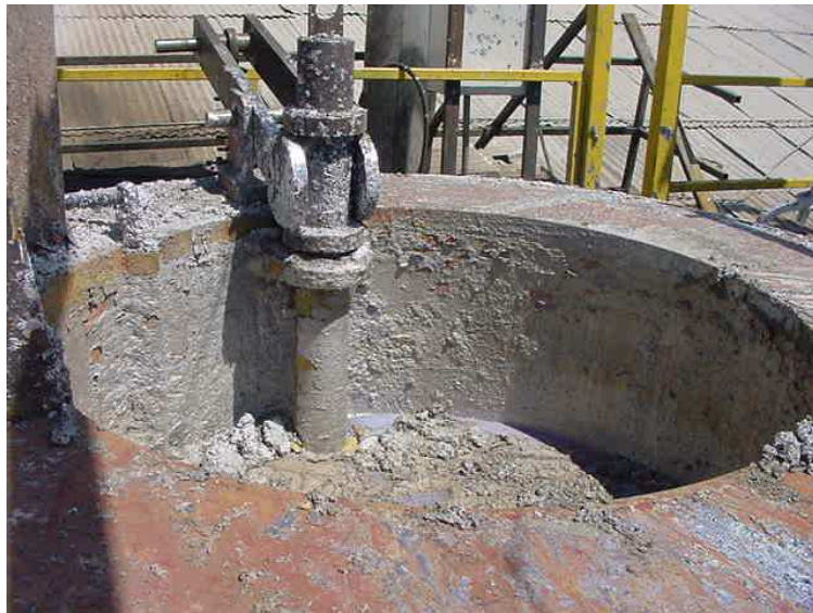
Figura 4.3: Detalle interior olla de fundición de aleación para planchas.
