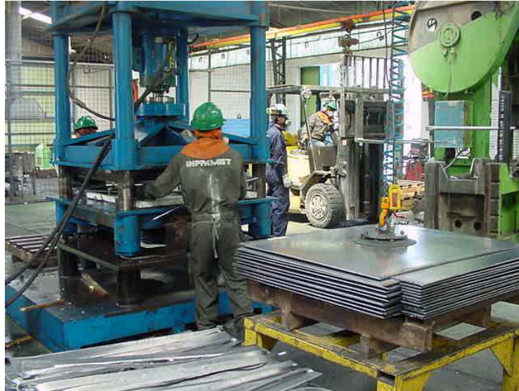
Figura 4.7: Conformado de las planchas de Pb-Ca-Sn para un proyecto específico.
