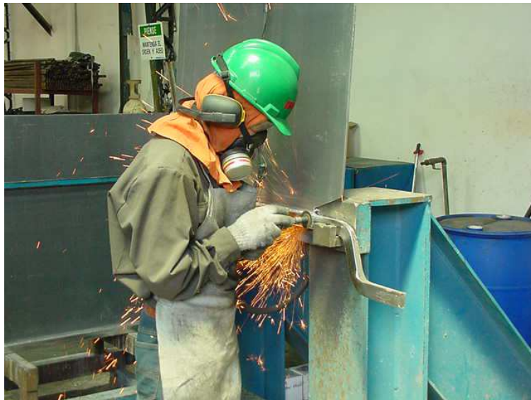
Figura 4.18: Limpieza después de aplicar el remache de seguridad.
