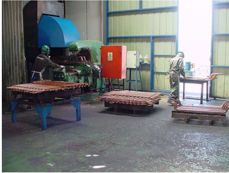
Figura 4.10: Celda de manufactura preparación barras de Cu.
