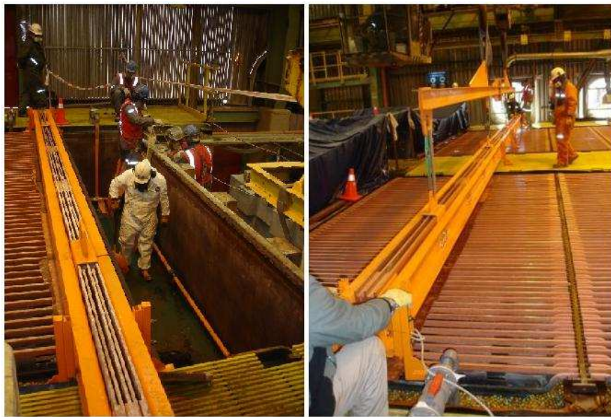
Figura 3.5: Celdas de electro-obtención. izq: celda vacía donde se observa el ducto de alimentación; der: celda cargada con cátodos y ánodos para la electro obtención de cobre.
