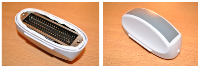
Figura 6: Fotografía del cabezal piezoeléctrico utilizado.
