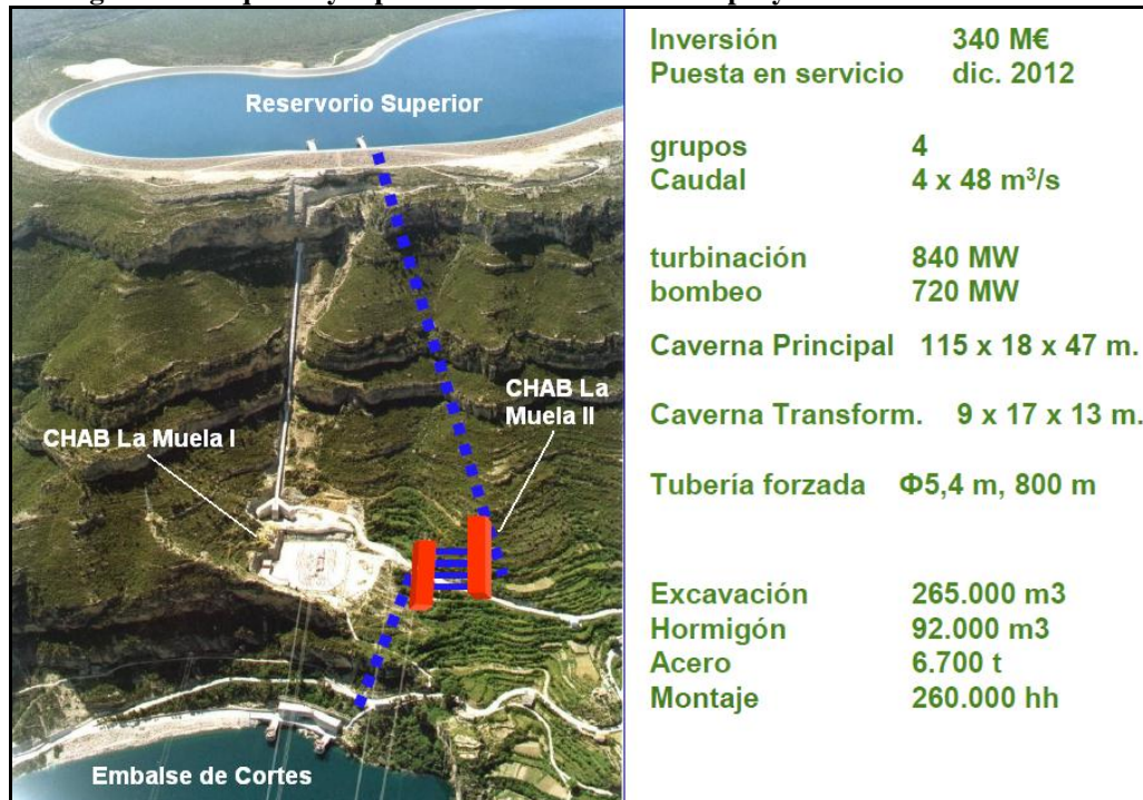
Figura 28: Esquema y especificaciones de diseño del proyecto CHAB La Muela II.
