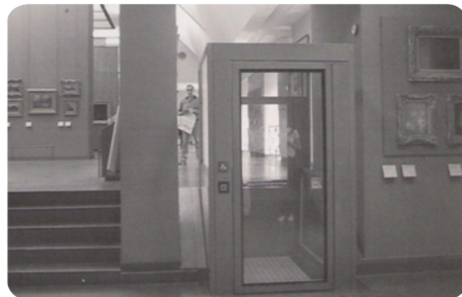
Fig. Corporación Ciudad Accesible (2011) Manual de accesibilidad Universal. Ascensor entre pisos (superior). Ascensor para salvar desniveles menores (inferior).
