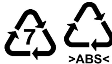
Figura 58. Identificación del plástico ABS.
