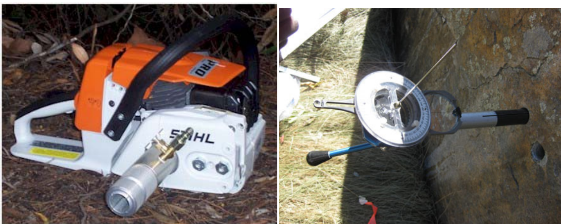
Figura 7. Moto sierra STIHL modificada por Pomeroy e instrumento de orientación para los orificios dejados por la máquina.
