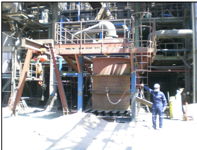
Figura 18: Planta piloto-industrial de conversión continua en lecho empacado.
