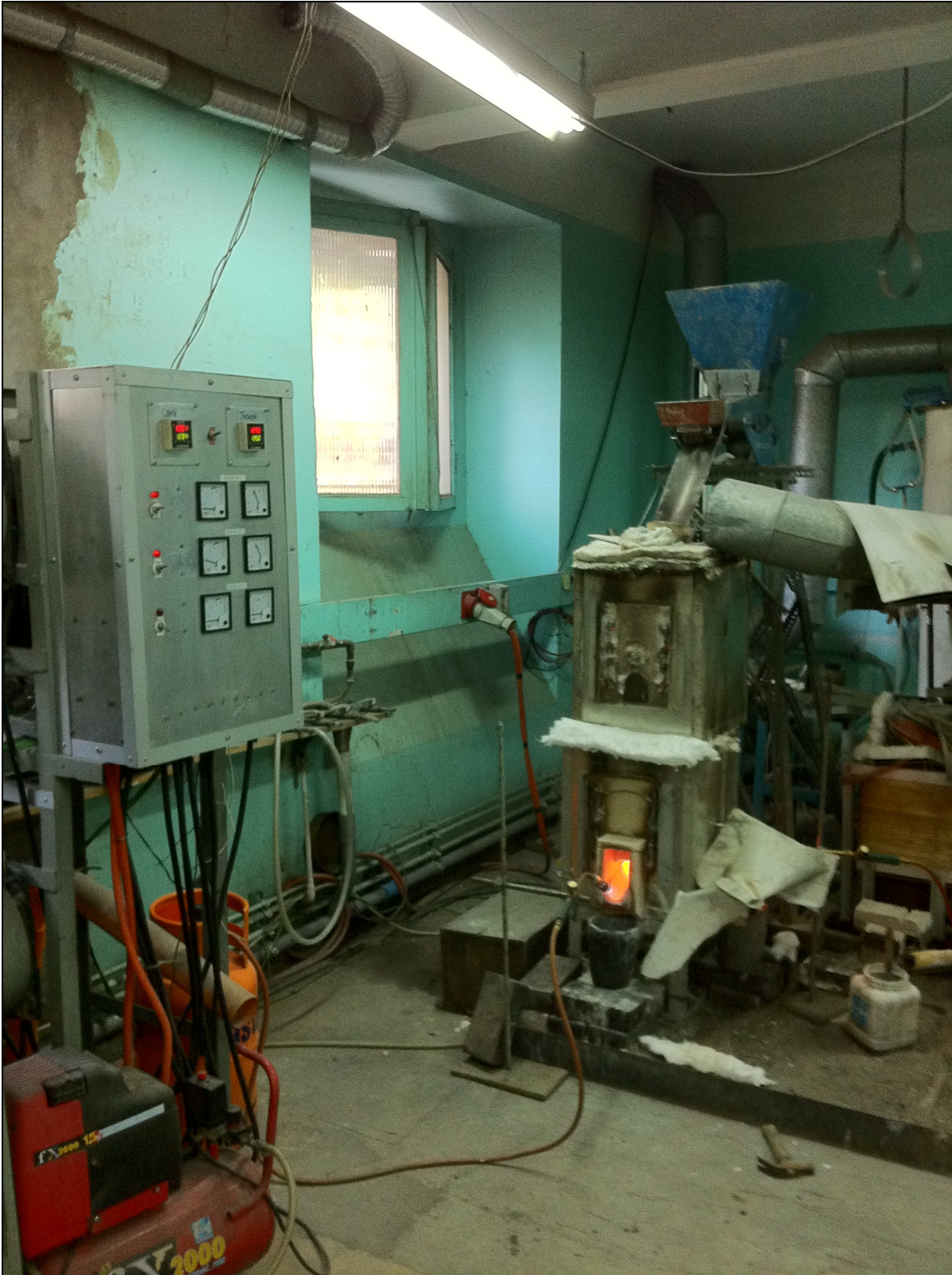
Figura 45: Instalación de conversión continua en lecho empacado a escala laboratorio.
