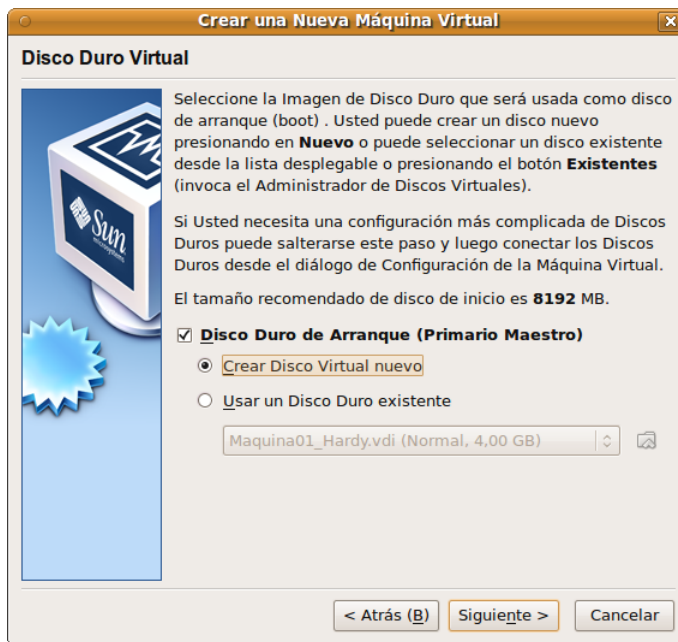
FIGURA 8.3: CREACIÓN DE DISCO DURO PARA MÁQUINA VIRTUAL.
