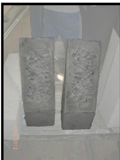
Figura 5. 9: Falla típica prismas fabricados con hormigón estructural y con tratamiento de picado (50% de la superficie).
