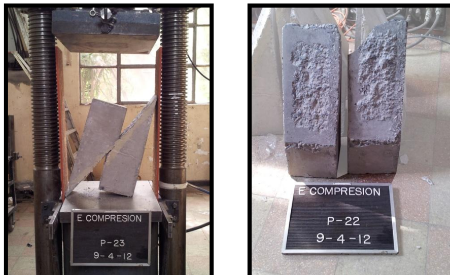
Figura 5. 3: Falla típica prismas fabricados con hormigón de pavimento y junta moldeada con tratamiento de picado.
