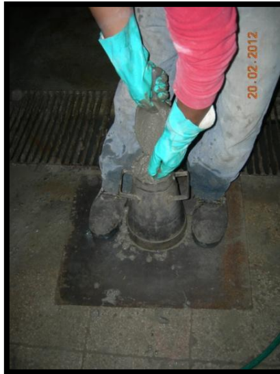
Figura 4. 6: Asentamiento de cono de Abrams.
