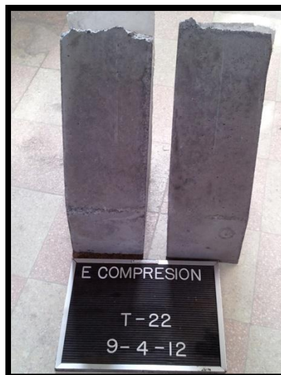
Figura 5. 13: Falla típica prismas fabricados con hormigón de pavimento y junta moldeada sin tratamiento de superficie.
