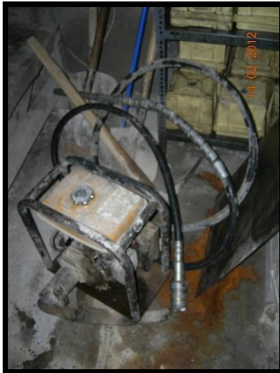
Figura 4. 8: Sonda y motor utilizados en la compactación de los prismas.
