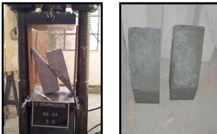
Figura 5. 8: Falla típica para los prismas fabricados con hormigón estructural y con tratamiento de puente de adherencia.
