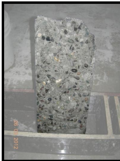
Figura 4. 15: Superficie de fractura por hendimiento.
