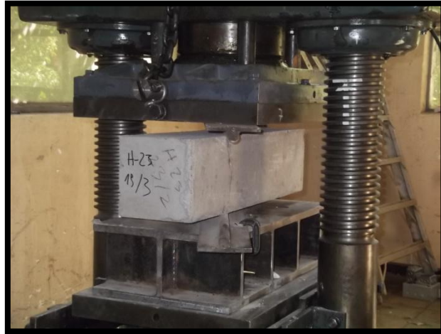
Figura 4. 14: Fractura por hendimiento.
