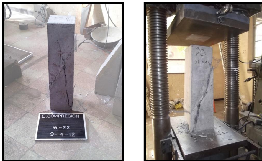
Figura 5. 4: Falla típica prismas fabricados con hormigón de pavimento y junta moldeada con tratamiento de malla metálica galvanizada.
