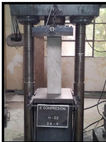
Figura 4. 22: Disposición del prisma para el ensayo de cizalle.
