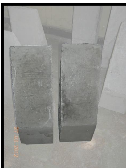
Figura 5. 7: Falla típica prismas fabricados con hormigón estructural y sin tratamiento de superficie.
