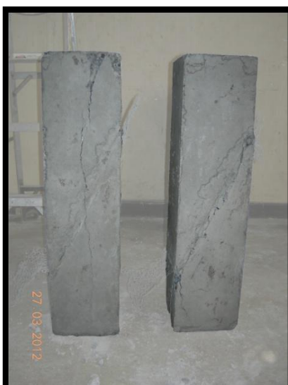
Figura 5. 10: Falla típica prismas fabricados con hormigón estructural y con tratamiento de malla de gallinero.
