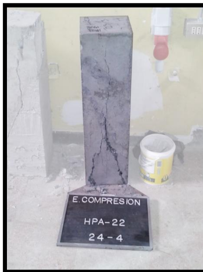
Figura 5. 614: Falla típica prismas fabricados con hormigón de pavimento, con plano de fractura por hendimiento y con puente de adherencia.
