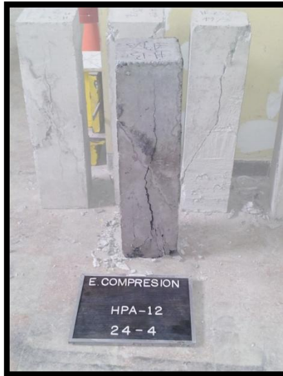
Figura 5. 115: Falla típica prismas de hormigón estructural, con plano de fractura por hendimiento y con puente de adherencia.
