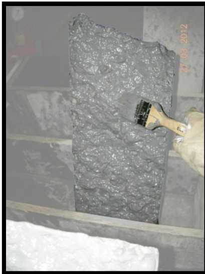
Figura 4. 16: Superficie de fractura por hendimiento más puente de adherencia.
