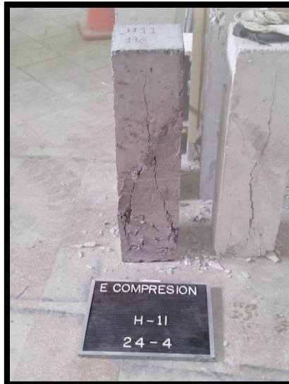
Figura 5. 11: Falla típica prismas de hormigón estructural, con plano de fractura por hendimiento y sin tratamiento.
