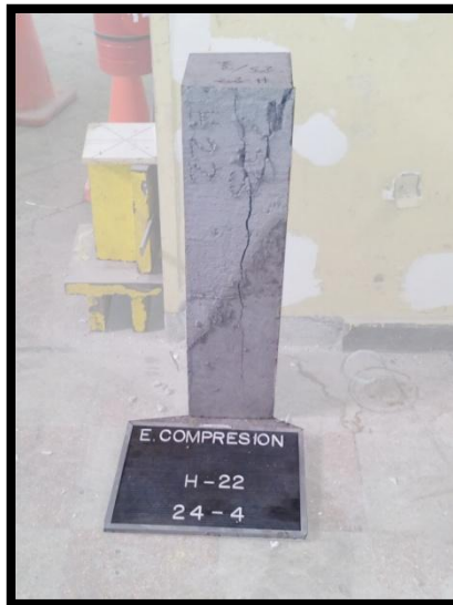
Figura 5. 5: Falla típica prismas fabricados con hormigón de pavimento, con plano de fractura por hendimiento y sin tratamiento.
