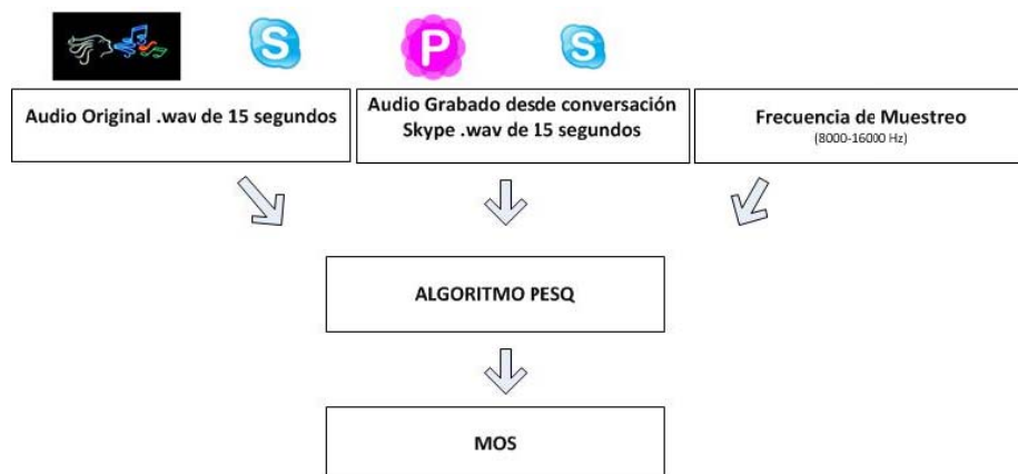
ILUSTRACIÓN 79: PROCEDIMIENTO PESQ CON SKYPE EN PRUEBA DE CONCEPTO 2
