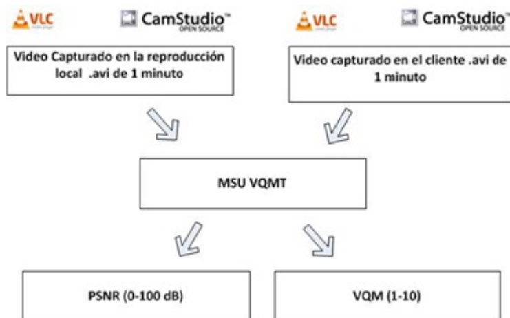
ILUSTRACIÓN 83: PROCEDIMIENTO PRUEBA DE CONCEPTO 4, CASO 1
