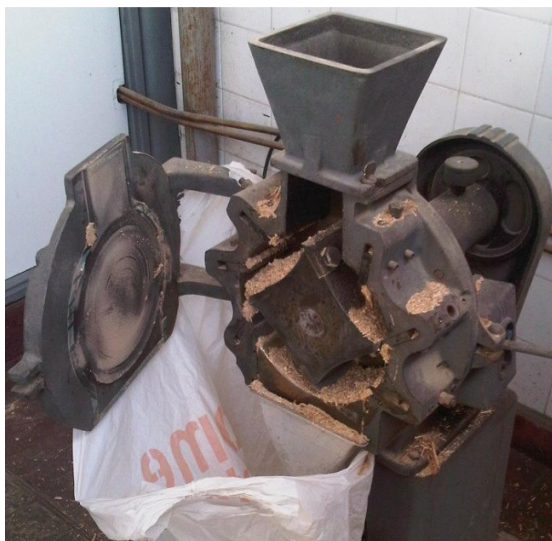
Imagen B-1: Molino utilizado para la reducción de tamaño del eucalipto
