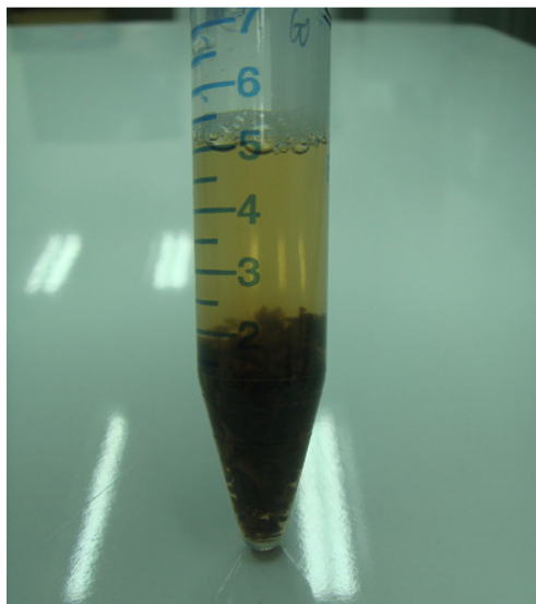
Imagen 6-2: Tubo Falcon de 15 ml con el material lignocelulósico, las enzimas y el buffer
