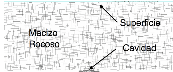
(b) Cavidad inestable. Fracturamiento y desprendimiento de material del macizo rocoso.
