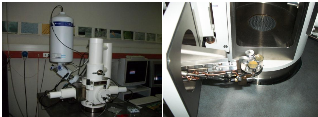
Figura 34. Equipo de SEM-EDS (izquierda). Detalle de 4 discos ubicados en la cámara de vacío para analizar con SEM-EDS (derecha).
