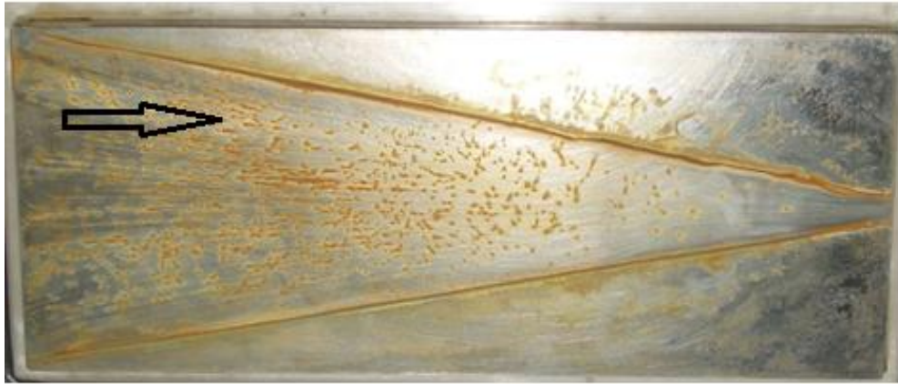
Figura 51. Fotografía placa 5. 0,01 M NaCl y 5 l/min. La flecha indica la dirección del flujo.
