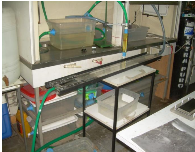
Figura 29. Foto del equipo de corrosión instalado.
