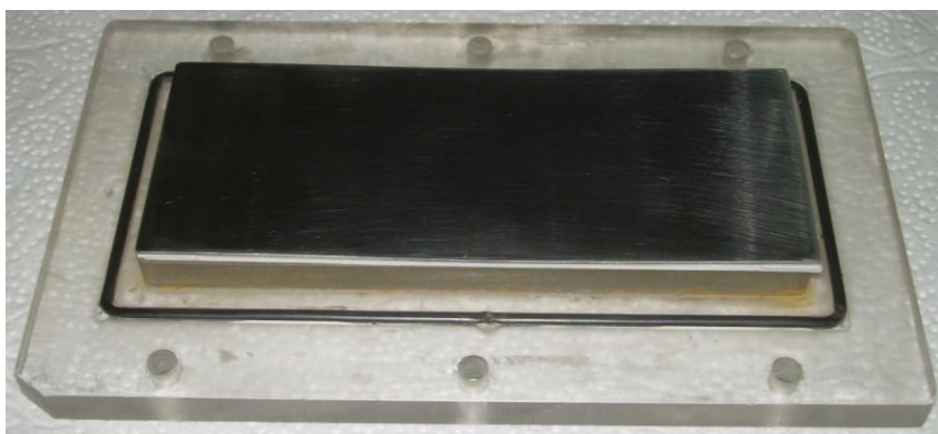
Figura 31. Placa de acero pulida y colocada en la tapa de acrílico.
