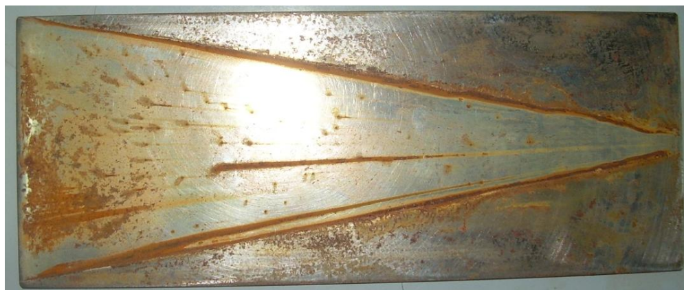
Figura 50. Placa 4 después de 4 horas bajo un caudal de 10[l/min] en solución acuosa al 0,01 M de NaCl.
