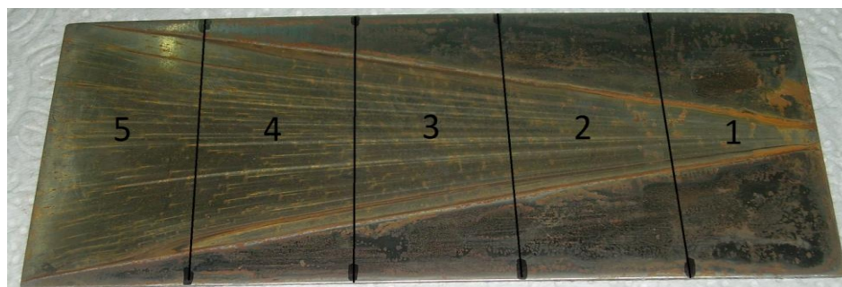
Figura 33. Placa de acero corroída con las 5 secciones numeradas y demarcadas.
