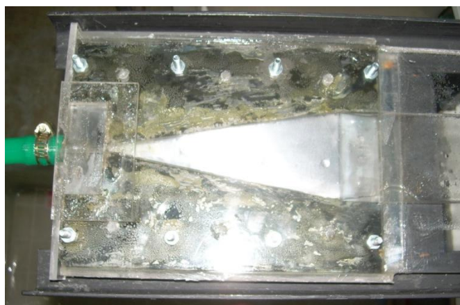
Figura 30. Detalle de la placa de acero ubicada en la zona triangular de la celda de corrosión
