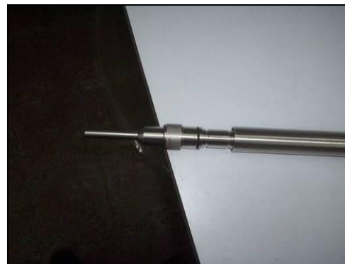
Figura 6 A la izquierda, parte superior bailer, conexión con manguera; a la derecha, parte inferior bailer, entrada de agua
