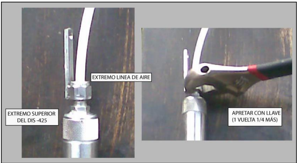
Figura 3 Detalle conexión manguera.
