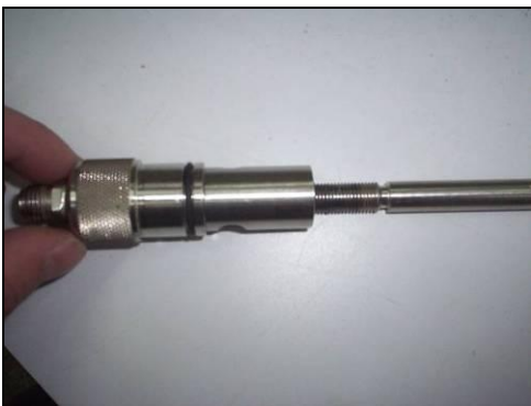
Figura 6 A la izquierda, parte superior bailer, conexión con manguera; a la derecha, parte inferior bailer, entrada de agua
