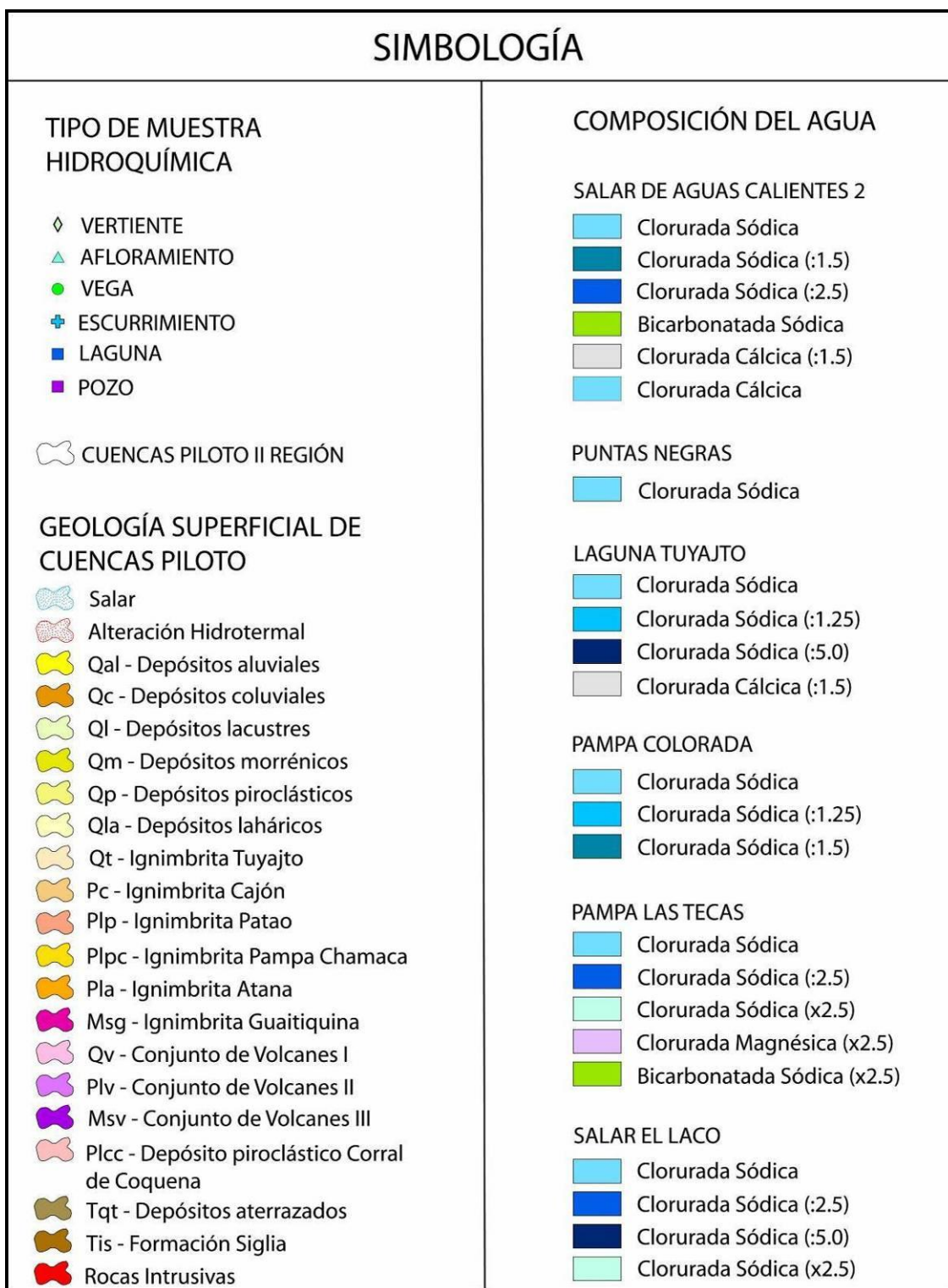
Figura 8.14 Simbología de Geología Superficial y Diagramas de Stiff de las cuencas piloto de la II Región de Chile. Los valores en paréntesis de las composiciones de agua, indican si los valores graficados han sido amplificados (X) o simpleficados (:).
