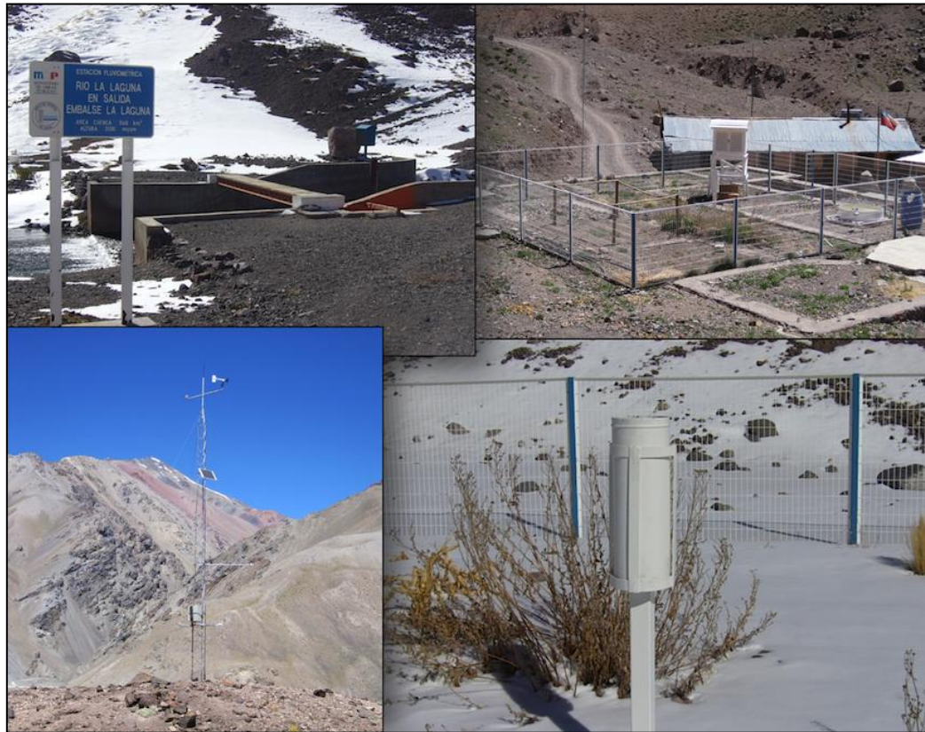
Figura 5 Las fotografías muestran las estaciones meteorológicas cercanas al embalse. En la esquina superior izquierda se ve la estación fluviométrica instalada aguas abajo del embalse. En la imagen superior derecha se ve la estación meteorológica y el patio donde se realiza la medición de altura de nieve de la DGA. En la imagen inferior derecha se muestra el pluviómetro de la misma estación DGA. La estación automática del CEAZA se ve en la esquina inferior izquierda.
