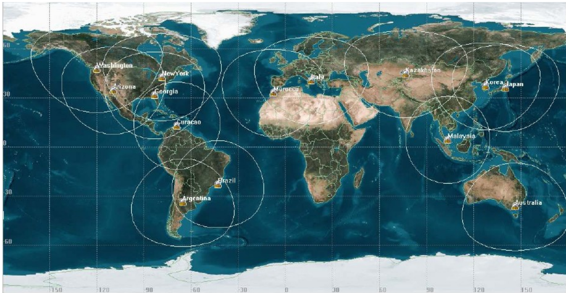
Figura N°8: Estaciones terrestres (GES) de la red Orbcomm, cuyos radios corresponden a las zonas de cobertura de este sistema [3]
