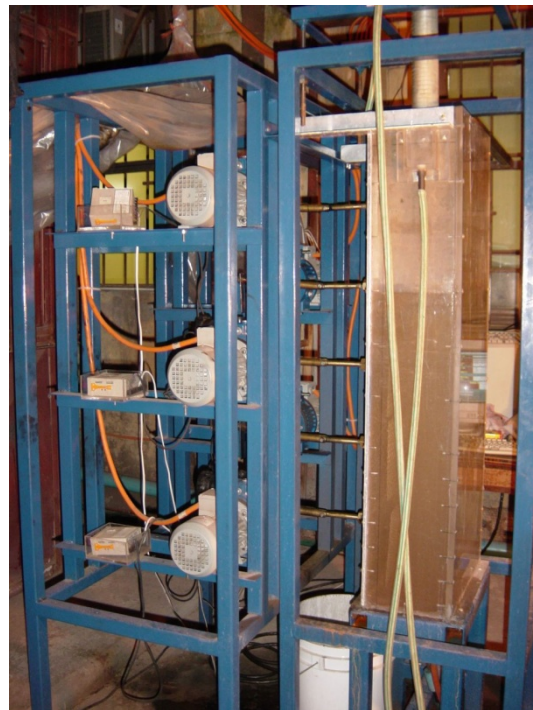
h) Estructura de soporte de motores y columna
